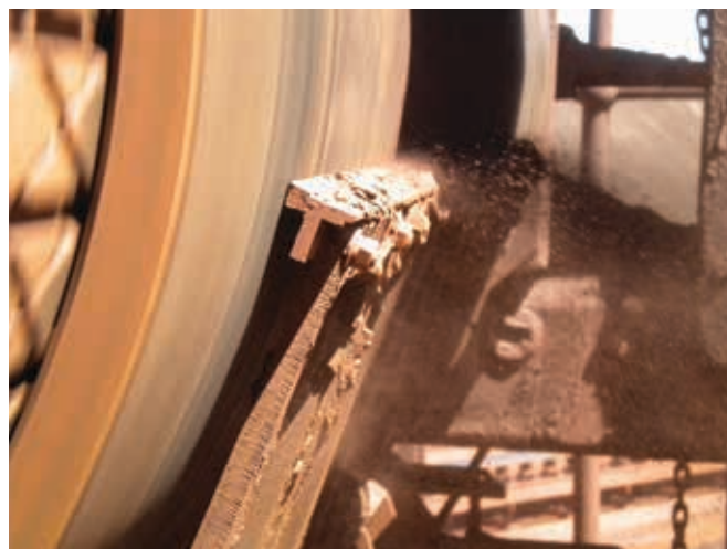
Ilustracja: Zgarniacz czołowy H-Type V-Tip
