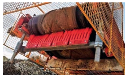
Zgarniacz grzebienny zamontowany pod bębniem zrzutowym na taśmie z profilem chevron
