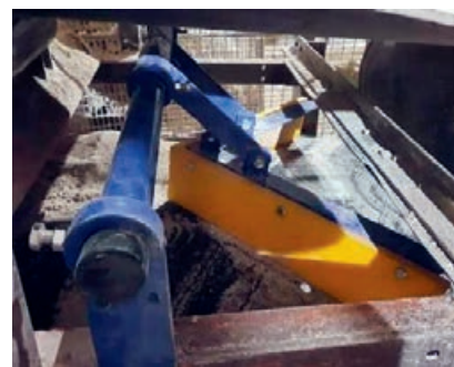
Pług zgarniający zamontowany na stronie bieżnej taśmy przed bębniem zwrotnym
